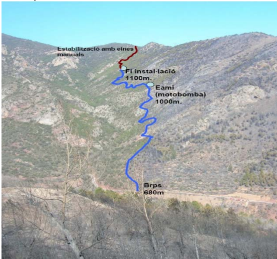
Imagen 2: Incendio forestal de Gerri de la Sal, marzo 2012. Maniobra combinada con EAMI 1 o Básico. Instalación BRP + EAMI 1 + herramientas manuales. Fuente: Bomberos
