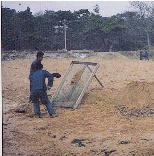
Figura A15.5 Tamisat manual. Tècnica per a petita escala per a la separació de sorra neta amb hidrocarburs (Font: technical iinformacions paper. ITOFF)
